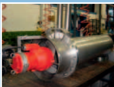
Pompa di ricircolo in costruzione Recirculation pump under construction
